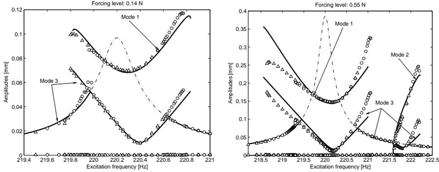
**Figure 2.** Comparaison modèle ('-') / expérience ('o', '\Delta')
