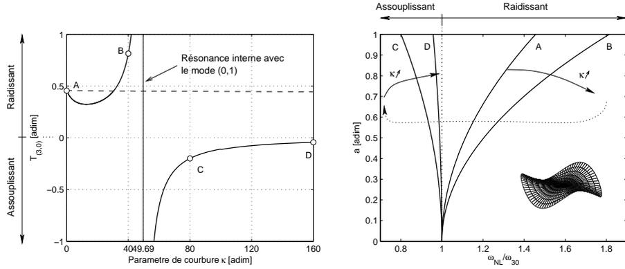
**Figure 1.** Comportement raidissant et assouplissant du mode  $(3,0)$  de la coque. À gauche, évolution du paramètre  $T_{(3,0)}$  en fonction de  $\kappa = a^4/R^2h^2$ ; à droite, 4 évolutions de  $\omega_{NL}/\omega_{30}$  en fonction de l'amplitude des oscillations, pour les 4 valeurs de  $\kappa$  (A, B, C et D) représentées à gauche par des 'o'.
