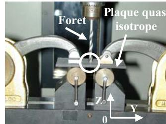
**Figure 5.** *Montage expérimental des essais de poinçonnement*
