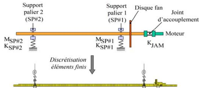
Figure 3. Modèle éléments finis du banc Dynamique D'Ensemble
