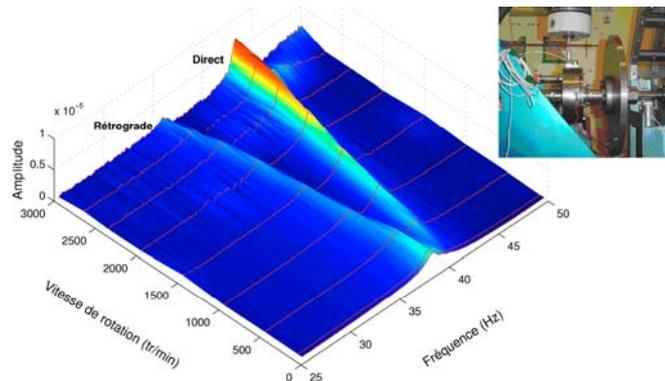
**Figure 4.** Waterfall expérimental et dispositif expérimental associé
