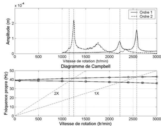
**Figure 5.** Essais de type « Order Tracking »
