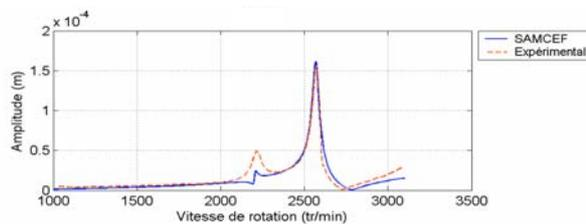
**Figure 7.** Comparaison expérience-calcul des réponses à balourd
