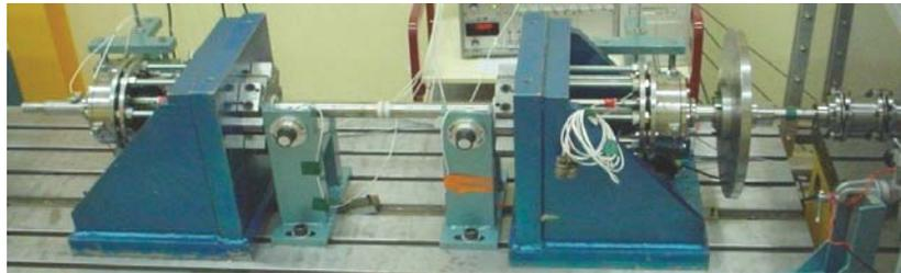
Figure 1. Banc d'essai « *Dynamique D'Ensemble* » mono-rotor
