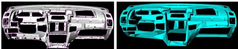
**Figure 2.** Exemple de préparation d'un modèle de planche de bord (Courtoisie Renault) à partir d'une représentation CAO. Les traitements réalisés comportent à la fois des changements de forme et de topologie.
