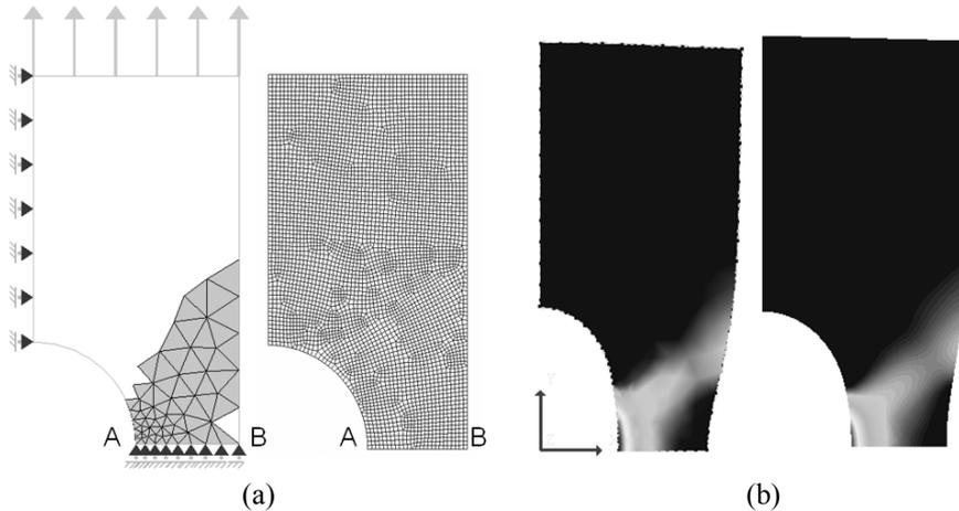
**Figure 5.** Comparaison BEM/FEM : (a) maillage KSP et maillage ABAQUS, (b) champ de déformations plastiques cumulées KSP et ABAQUS.
