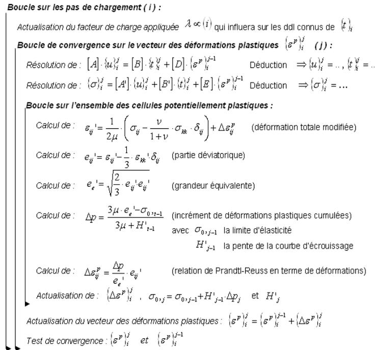
Figure 3. Algorithme élastoplastique
