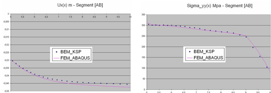
**Figure 4.** Comparaison des résultats numériques en déplacement et contraintes
