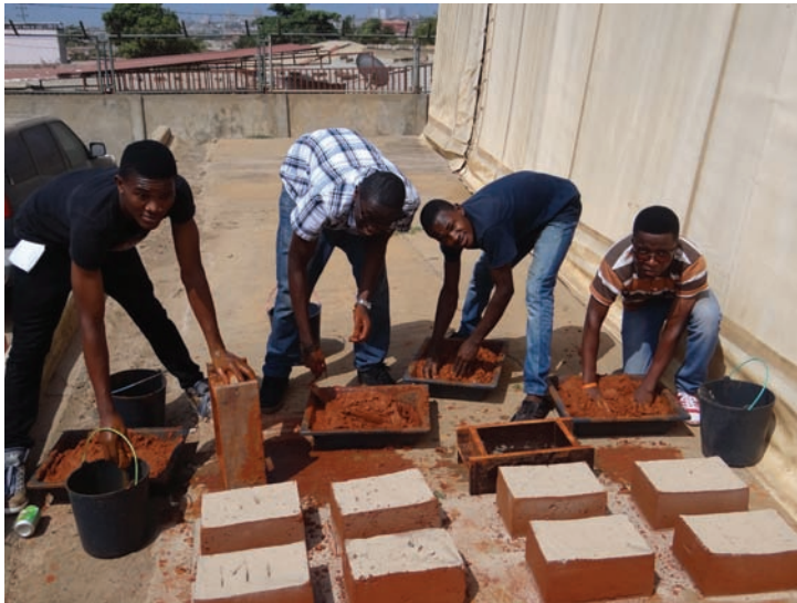
Fig. 9 Estudiantes finalistas Medio Técnico, técnicos de obra, ejercicio de producción de adobes, 2014
