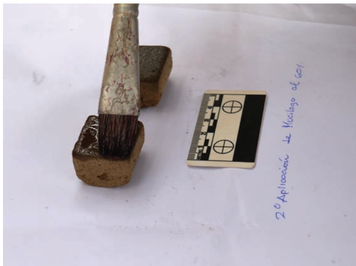
Fig. 6 Muestra tratada con solución de mucilago al 60%
