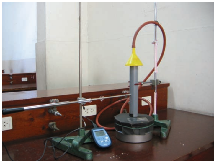
Fig. 3 Instrumentación utilizada para la prueba de erosión
