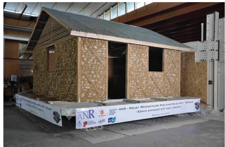
Fig. 6 Essai sur table vibrante
