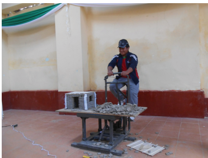
Fig. 5 Demostraciones con la mesa vibratoria portátil PUCP
