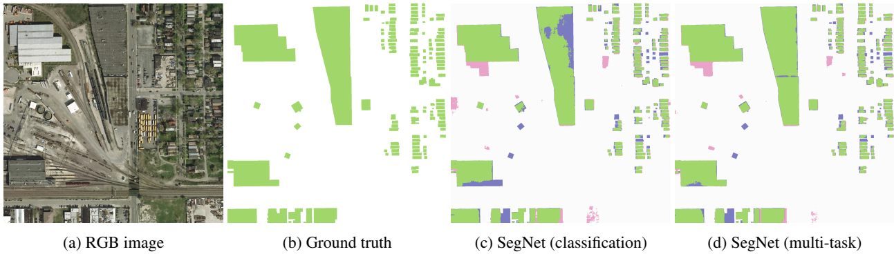
FIGURE 5 – Extrait des résultats de segmentation sur le jeu de données INRIA Aerial Image Labeling. Les pixels corrects sont en vert, les faux positifs en rose et les faux négatifs en bleu. L’approche multi-tâches capture mieux la structure spatiale des objets.
