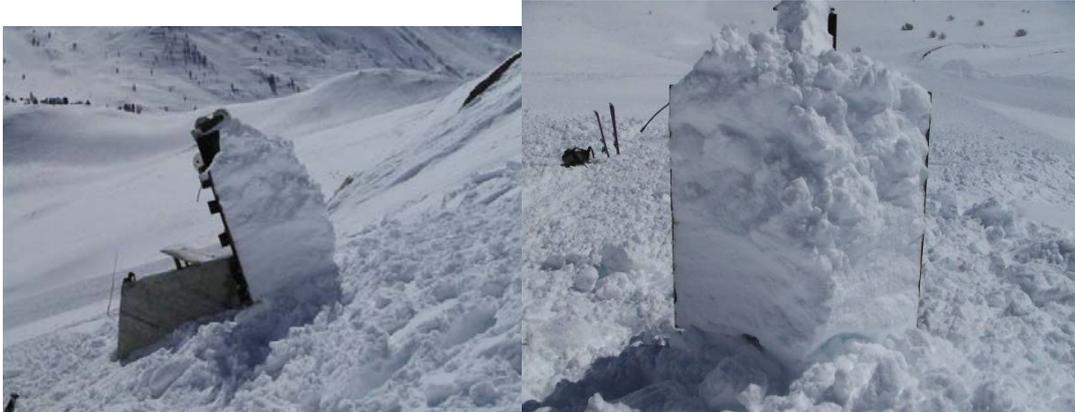
Figure 28 : Zone morte d'accumulation sur la plaque
