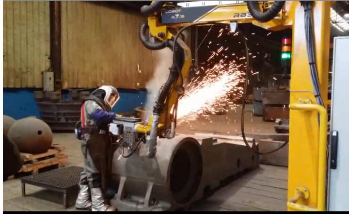
Figure 11. Cobot RB3D dans une situation de meulage (©INRS/Ferry Capitain)
