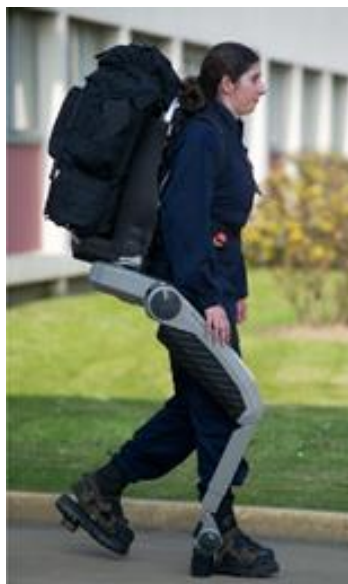
Figure 6. Exosquelette « Hercule » (Crédits RB3D)
