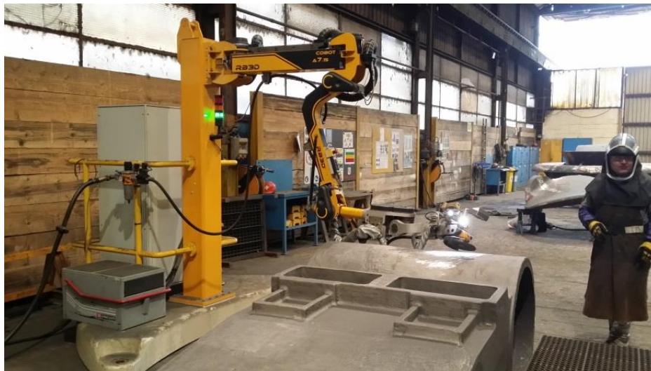
Figure 28. Poste de parachèvement avec le Cobot 7 axes (©INRS/Ferry CAPITAIN)
