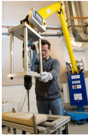
Figure 16. Manipulateur à compensation de masse de la société Sarrazin technologies. Crédit photo : Philippe Stroppa/CEA
