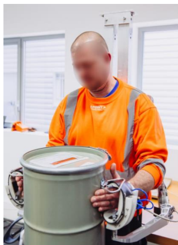
Figure 15. Exo-Up avec bras et jambes (Crédits photos Point P)
