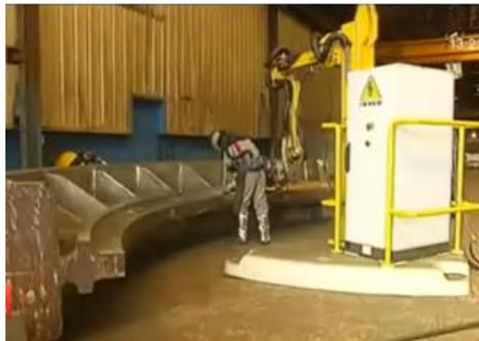
Figure 30. Positionnement du cobot par rapport à la pièce à ébarber (©INRS/FERRY CAPITAIN)
