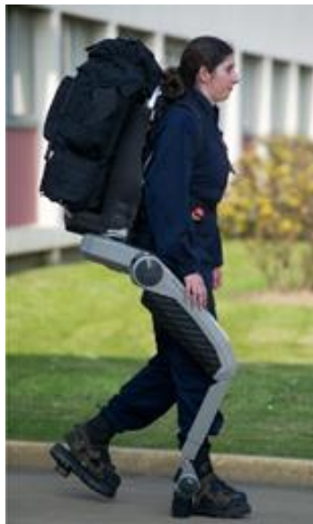
Figure 6. Exosquelette « Hercule » (Crédits RB3D)
