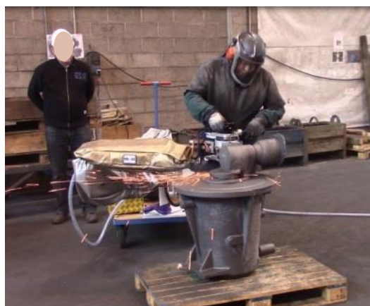
Figure 32. Essais de l'assistance au meulage (©INRS/PTP Industry/RB3D)
