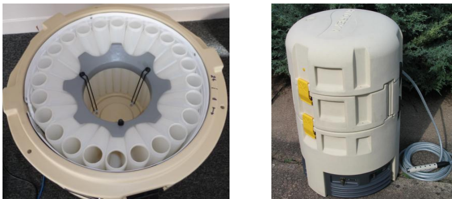
Figure 3 : Prélèvement réfrigéré 24 flacons
