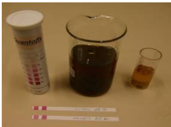
Photo 8 : Analyse des ions Ammonium dans un lixiviat (dilution 10 et 20)
