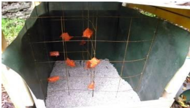
Photo 6 : Implantation de thermoboutons protégés par du scotch et une enveloppe étanche (Aire de Nyons étanche et à gestion à minima)
