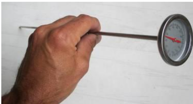
Photo 7 : Thermomètre à compost
