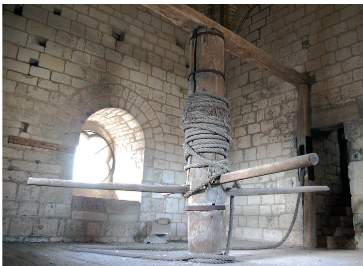
Fig. I-20 > Cabestan à arbre vertical avec son cordage, 1745, tour sud.
