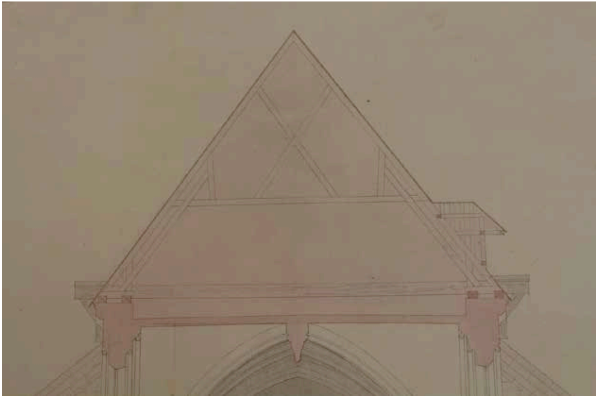
Élévation sur le chœur en 1890 : détail sur la charpente avec entrait ou tirant rajouté sous l'Ancien régime ; mise au net du n° 29189 ? (dessin de J-C. Danjoy - MAP 082/14/1015, document 517).
