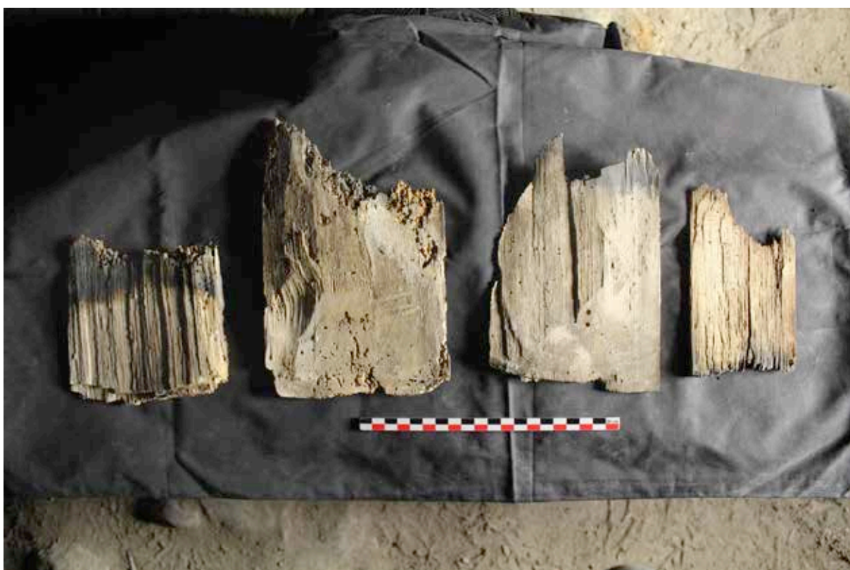
III. 9 — Déambulatoire, travée 30 : couchis déposés pour analyse dendrochronologique (cl. S. Aumard, CEM).
