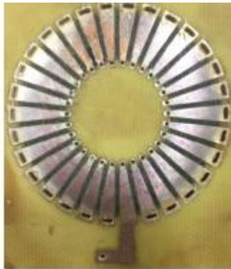
Fig. 4 - Photographie du prototype d'inductance
