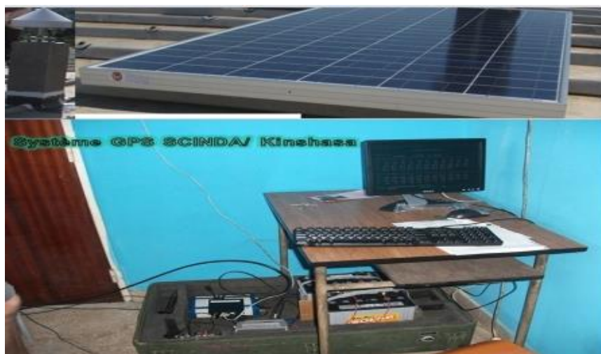
Figure 1: Dispositif expérimental du Scintillateur GPS SCINDA implanté à la Faculté Polytechnique de l'Université de Kinshasa.
