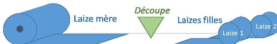
Figure 1 : Modèle de découpe d'une laize mere en plusieurs laizes filles
