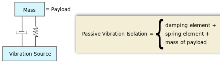
FIGURE 4.1 – Schéma d'un système passif pour isolation vibratoire
