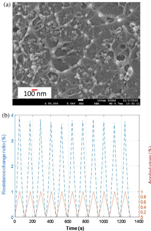
FIGURE 4.10 – Crédits : Elsevier a) image MEB des nanocomposites avec 6.5% de noir de carbone/PVDF; b) réponse électro-mécanique du nanocomposite préparé
