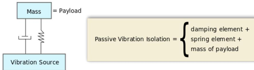
FIGURE 4.1 – Schéma d'un système passif pour isolation vibratoire
