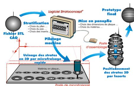
FIG. 1 – Principe du procédé de Stratoconception<sup>®</sup> (source CIRTES [13]).
