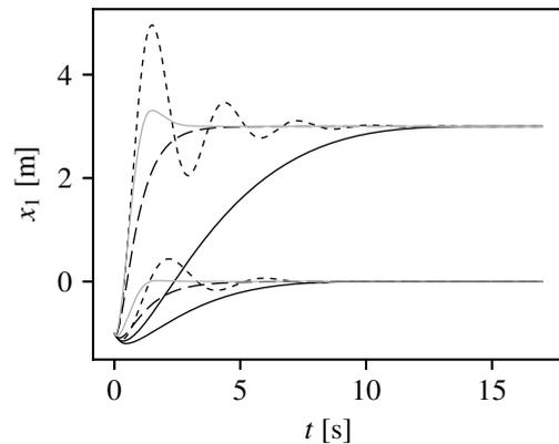
FIGURE 2 – Contrôle du système linéaire : évolution de la position dans le temps. Trajectoires vers l'origine sans contrôle (----), avec injection d'amortissement (---), en temps fini (—) et avec la méthode passive en temps fini (—). Trajectoires vers  $[3 \ 0]$  avec le contrôle par remodelage d'énergie (----), l'IDA-PBC (---), le contrôle en temps fini (—) et avec le contrôle passif en temps fini (—).
