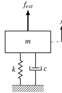
FIGURE 1 – Système masse-ressort-amortisseur
