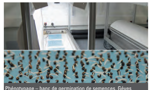
Phénotypage – banc de germination de semences, Gêves
