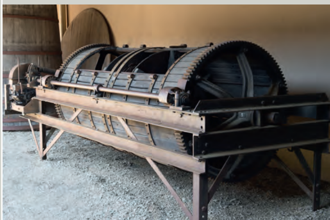
Pressoir horizontal à cage cylindrique tournantes fabriqué dans l'usine chalonaise CMMC, 1946. Collection Musée de la Vigne et du Vin d'Anjou
