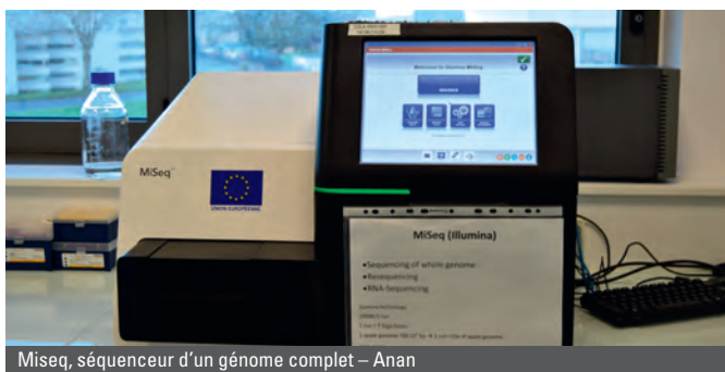
MiSeq, séquenceur d'un génome complet - Anan
