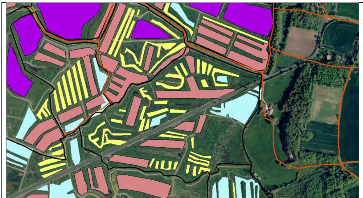
Figure 11: Essai d'identification des structures de marais sur fond orthophoto IGN - Secteur de St Jean d'Angle
