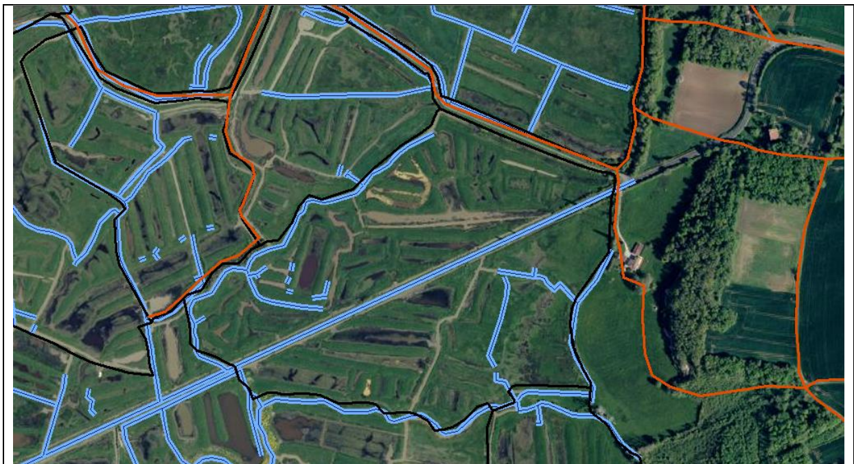
Figure 8: Tracé des prises de marais, chemins et chenaux sur Photo aérienne sur St Jean d'Angle
