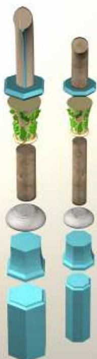
Fig. 24. Les composantes d'un support recevant un arc profilé en amande (sections hexagonales) ou en tore (sections octogonales) ; dessin schématique en décomposé
