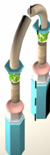
Fig. 25. Alignement des composantes d'une arcade selon l'axe déterminé par l'arc ; dessin schématique en décomposé
