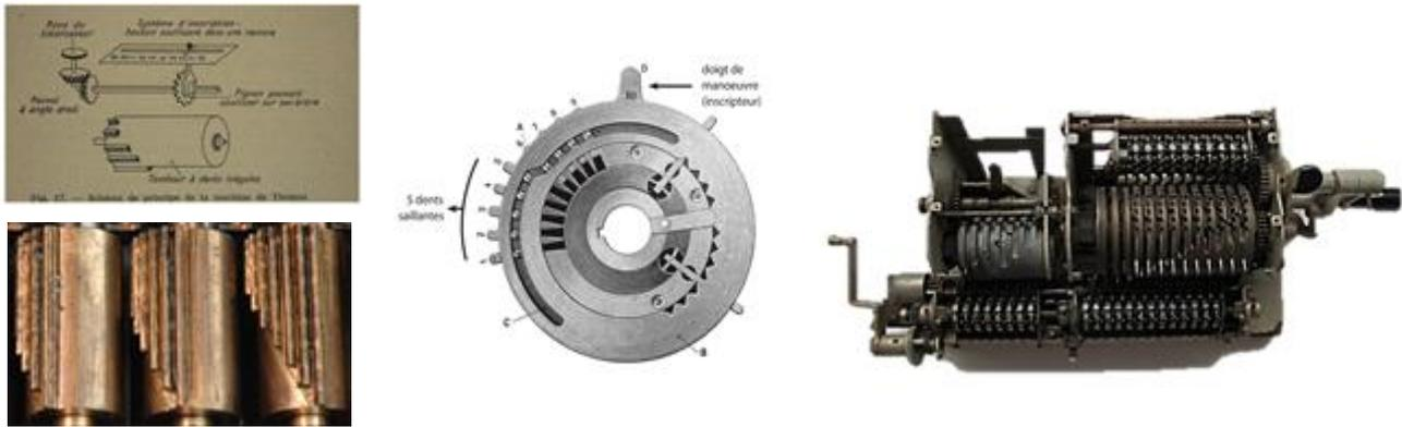
**Figure 12 : Schéma de fonctionnement de l'entraîneur de Leibniz et photo de trois cylindres à dents cannelées – Schéma explicatif d'un entraîneur Odhner – Multiplicatrice Odhner écorchée. (Images extraites des panneaux de l'exposition « Multipliez »).**
