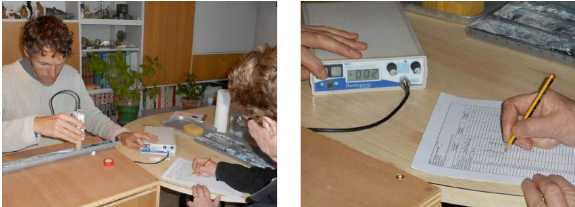
Fig. 9 : Mesure de la susceptibilité magnétique sur une carotte de MASF.3.
