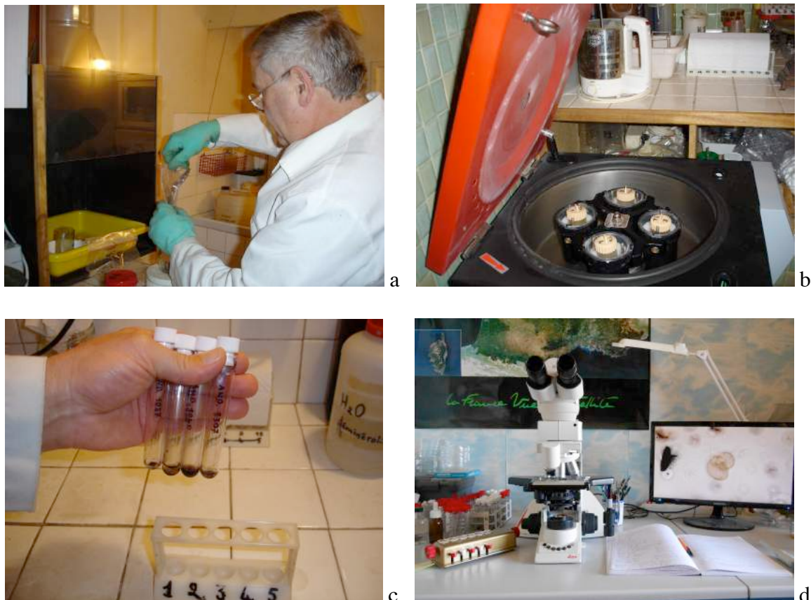
Fig. 10 : Quelques étapes de l'analyse pollinique : a- pesée (2 à 3 g environ) et mise en pot de l'échantillon pour le début de la préparation (eau, hexamétaphosphate) ; b- centrifugation ; c- culot prêt ; d- observation au microscope, détermination et comptage.
