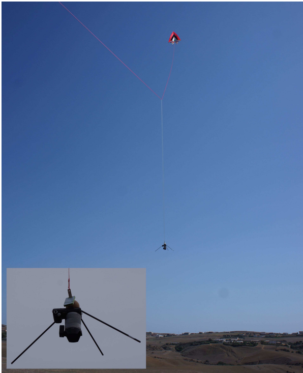
FIGURE 1: Dispositif de prise de vue avec pendule simple. En encadré, vue rapprochée de l'appareil photo muni d'un tripode. Le déclencheur automatique est fixé sur le pare soleil et l'enregistreur GPS est accroché au sommet de la plate-forme.
