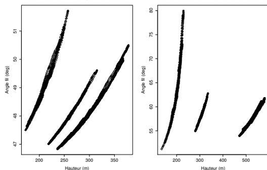
**FIGURE 2:** Exemple de caractéristiques mesurées pour deux ailes delta différentes. La figure de gauche présente les mesures réalisées lors d'un vol avec une aile delta de 4 m<sup>2</sup> à 3 longueurs de fil différentes. La figure de droite présente les mesures réalisées lors d'un vol avec une aile delta de 10m<sup>2</sup>, là encore avec 3 longueurs de fil différentes.
