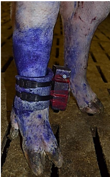
Figure 3 : Boîtier métallique contenant les accéléromètres, installé sur la patte arrière d'une truie, couvert de Cicalm®
