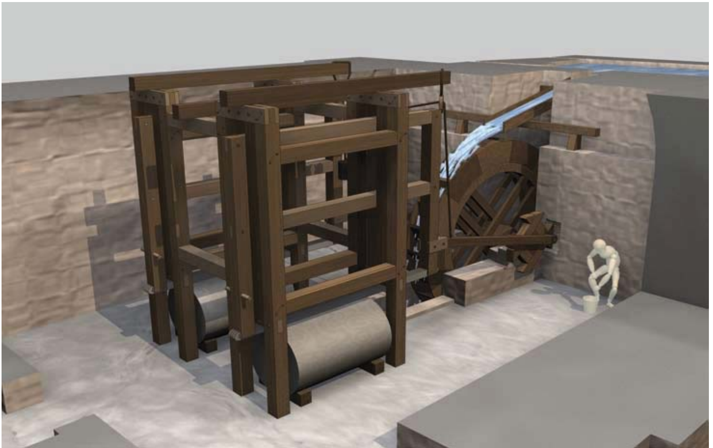
Fig. 10. Hypothèse récente de l'installation de sciage, exploitant les analyses de la restitution matérielle de 2007 (DAO Morin 2008).
