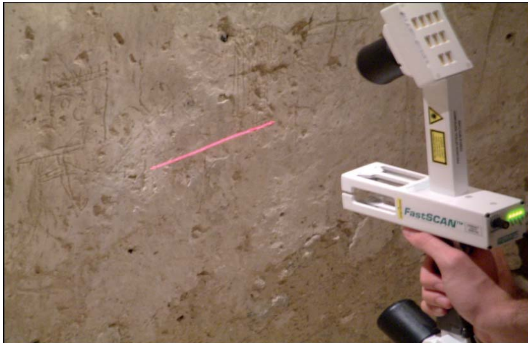
Fig. 8. Scanner à main Polhemus FastScan à moyenne portée.
