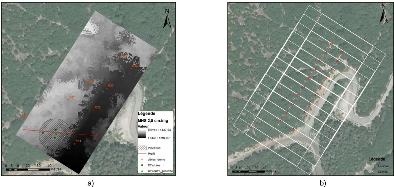
**Figure 1** : Zone d'étude SP3 survolée par le drone et mesurée sur une placette d'analyse de 15 m de rayon, MNS calculé à partir des images à 2,5 cm de résolution (a). Le plan de vol avec des recouvrements de 80 % ; les deux bandes de 10 photos ne sont pas prises en lacet mais dans le sens du vent de manière à augmenter l'autonomie du drone (b)
