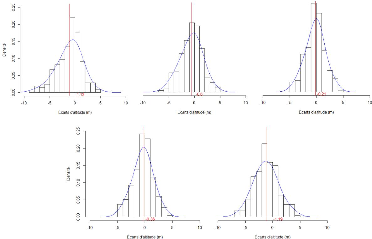
**Figure 3 :** Comparaison des écarts d'altitude sur la zone SP2 entre les MNS calculés à partir des images de résolution décroissante (0,025 m - 0,05 m - 0,10 m - 0,20 m - 0,40 m, de g. à d.). En rouge, la moyenne des écarts (biais), en bleu, la courbe de densité.
