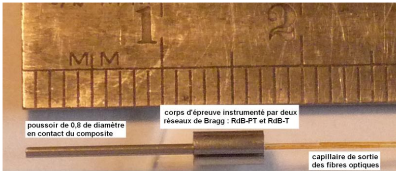
Figure 3 Corps d'épreuve cylindrique développé au cours du projet ELICo-CP avec transducteurs RdB pour la mesure de déformations et la compensation en température (d'après [2]). Reprinted from Eighth International Workshop on Structural Health Monitoring, 2011 Lancaster, PA: DEStech Publications, Inc.
