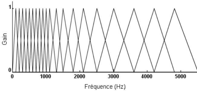
FIG. 3 – Banc de filtres comprenant 20 filtres triangulaires, en échelle Mel, conformément aux filtres utilisés pour le calcul des Mel Frequency Cepstral Coefficients (MFCCs) [6].
