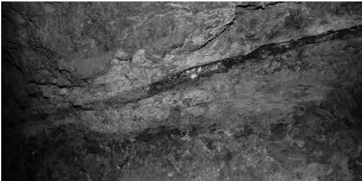
Lámina 11. Detalle del filón en el techo de la explotación vertical de la rafa principal.
