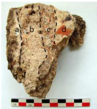
Figure 1 : PRL 5. On distingue les quatre couches de liant qui ont permis de réaliser cet ensemble. Il est difficile d'effectuer des observations sur de si faibles épaisseurs.
