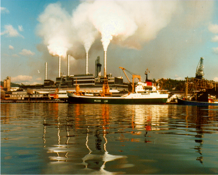
Abb 16: Bevor silica fume als Nebenprodukt der Silicium- und Ferrosiliciumproduktion marktfähig wurde, wurde es einfach in die Luft geblasen. Elkem Schmelzwerk Kristiansand, Norwegen 1970.
