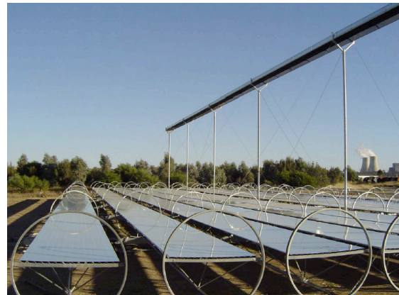
Figure 2 : Collecteur à miroirs de FRESNEL
