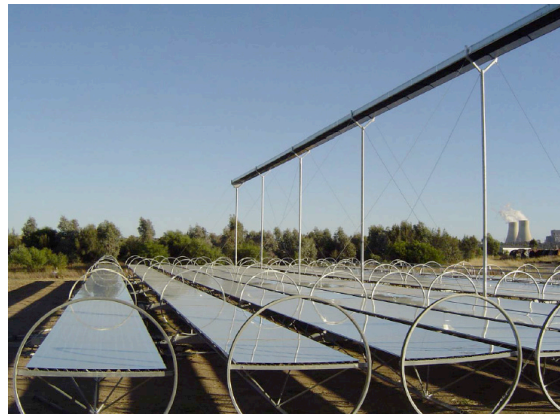
Figure 2 : Collecteur à miroirs de FRESNEL
