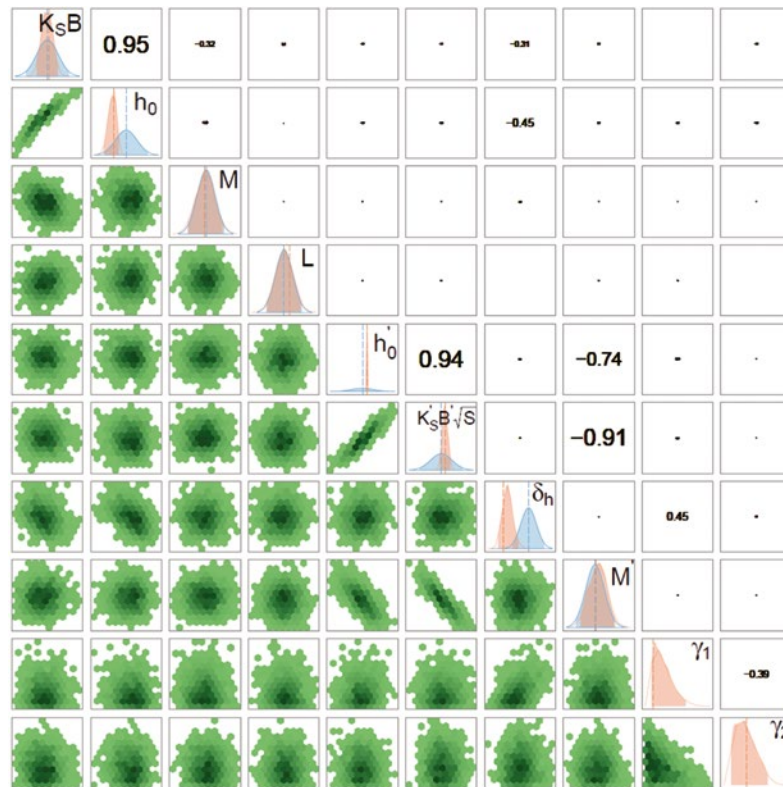
Figure 3 : BaRatin-SFD appliqué à l'Isère à Beaumont-Monteux, résultats des échantillonnages MCMC. La diagonale correspond aux densités marginales a priori (bleu) et a posteriori (rouge). Le triangle supérieur de la matrice correspond à la matrice de corrélation des paramètres tandis que le triangle inférieur présente les nuages de points des valeurs échantillonnées.
