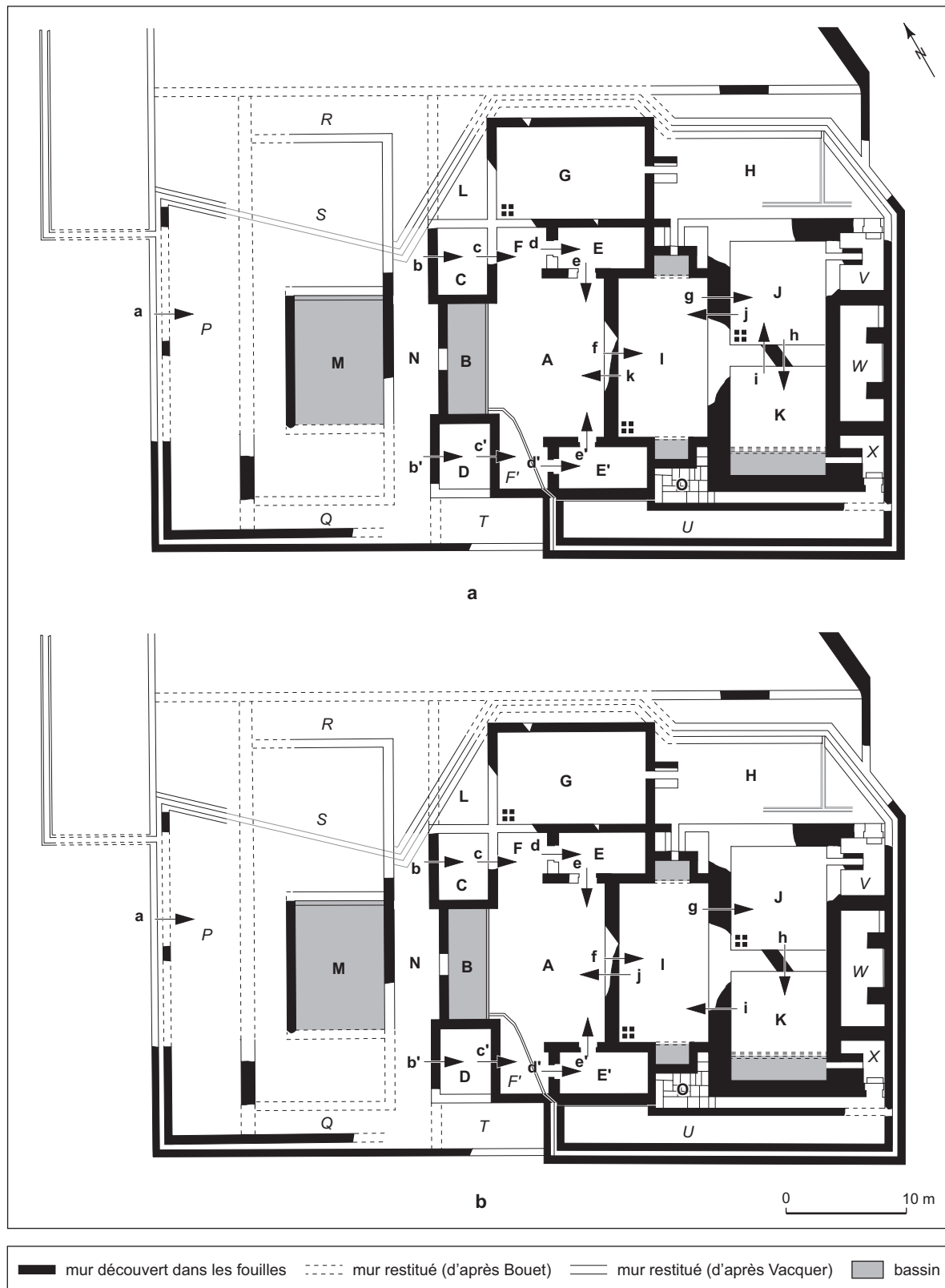
Fig. 8 – Thermes de la rue Gay-Lussac, hypothèses de restitution du cheminement des baigneurs (les lettres en romain correspondent à celles données par T. Vacquer ; celles en italique ont été ajoutées par nos soins) : a , cheminement à itinéraire rétrograde ; b , cheminement à itinéraire semi-rétrograde et semi-circulaire ; A, frigidarium ; B, piscina ; E, E', apodyteria (?) ; G, salle de sport et destrictarium pour sportifs ; H, V, X, chambres de chauffe ; I, tepidarium ; J, laconicum ; K, caldarium ; M, natatio ; N, Q, R, portiques ; P, portique ou xyste (?) ; S, palestra ; U, latrines ; W, salle de service (DAO : A. Bouet, Université Bordeaux-III).
