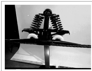
Figure 2. Pince débrayable (source Pomagalski).
