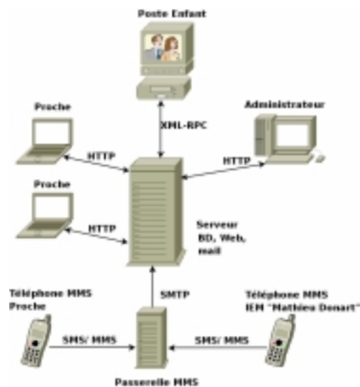
Figure 1. Architecture de la plate-forme.
