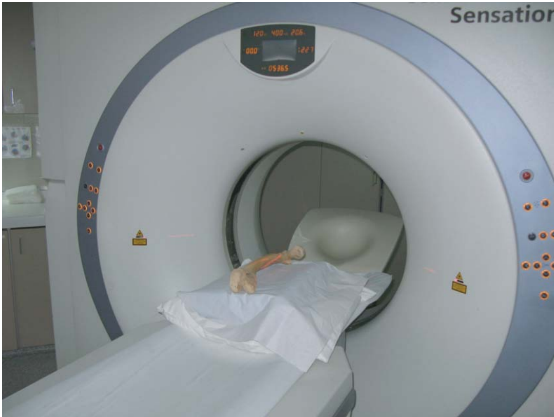
Fig. 4. Passage du fémur dans un scanner d'imagerie médicale au CHU de Bordeaux, Hôpital Haut Lévêque.
