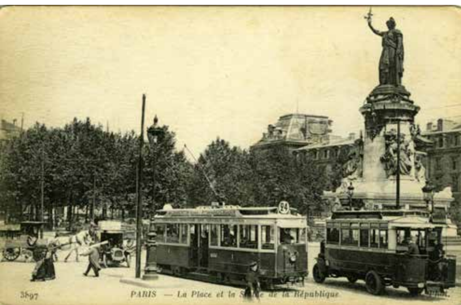
Tramway électrique de type G croisant un autobus Brillie-Schneider PB2, les deux de la Compagnie Générale des Omnibus (CGO) place de la République à Paris en 1913 © Collection AMTUIR - Le Musée des Transports Urbains de France
