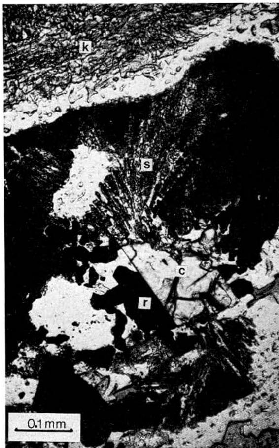
FIG. 2. — Corindon primaire ( $c$ ) en association épitaxiale avec le rutile ( $r$ ) dans la symplectite corindon II + quartz ( $s$ ) dérivant du disthène. Noter le contact plan entre les deux minéraux. Comparer avec Lasnier (1977), photos 61 à 64. K = kélyphitoïde.
